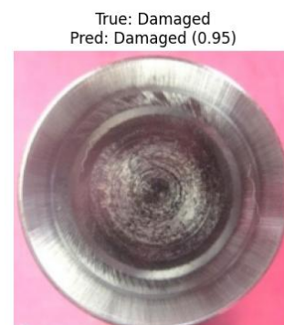
شکل ۵: نمونه خروجی مدل طبقه بندی (قطعه با احتمال ۹۵ درصد معیوب است)
